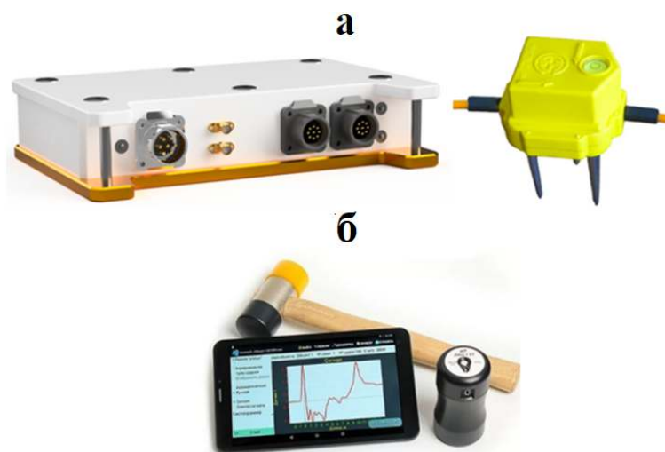
Рис. 2. Измерительное оборудование, состоящее из регистраторов сейсмических сигналов D-REG (слева) и геофонов GS-ONE DA (справа) (а); Устройство для диагностики свай Спектр 4.3 (б)
