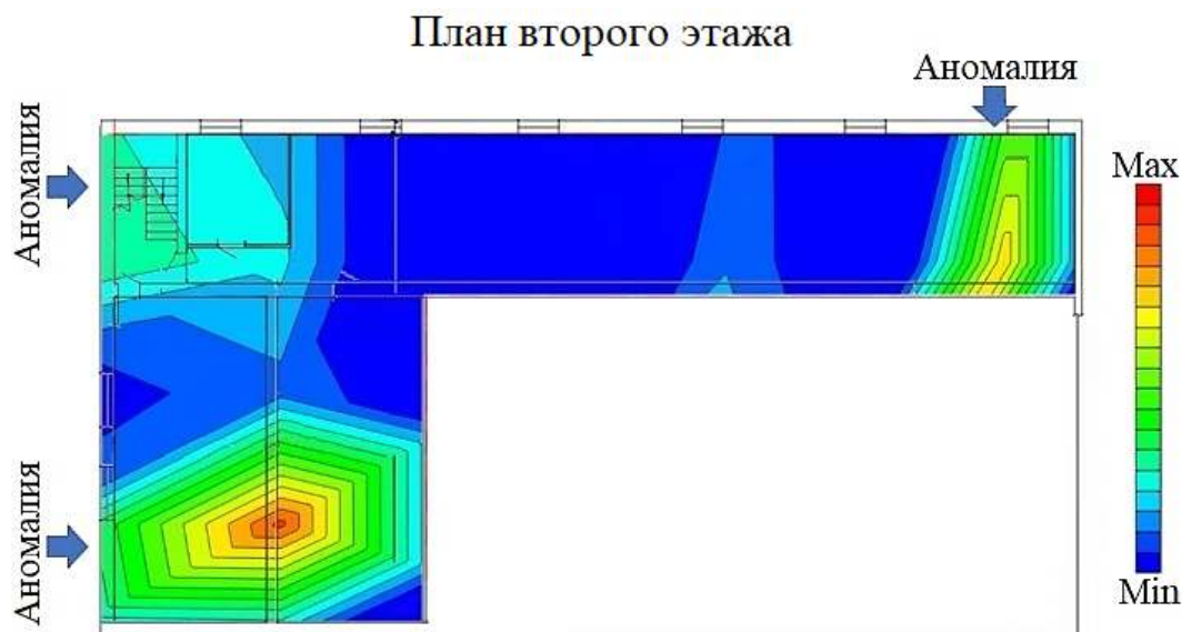
Рис. 7. Площадная съемка. Амплитудное распределение по сумме трех компонент (X, Y, Z) на втором этаже здания
