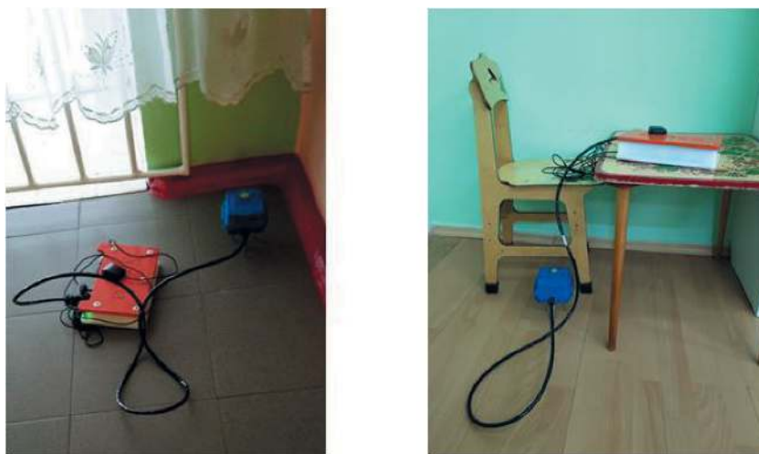
Рис. 2. Пример установки геофонов GS20DX и трехканальных автономных цифровых регистраторов D-REG на полу одного из объектов исследования
